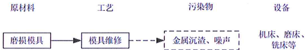
图 2-5 模具维修流程图
