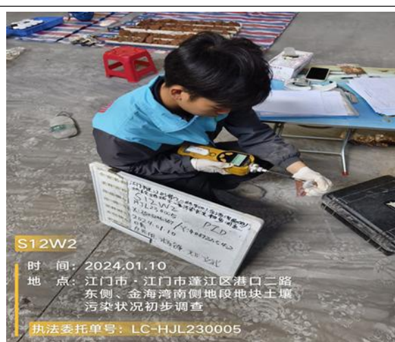
现场快速检测—PID
