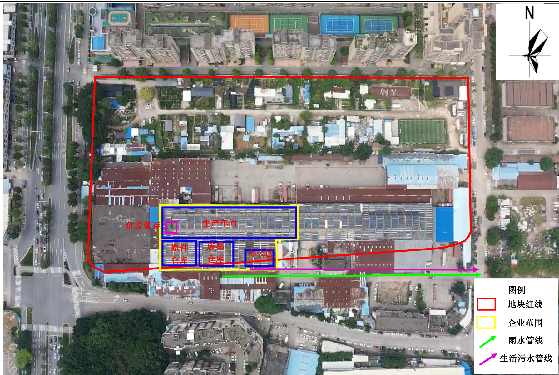
图 3.3-16 广东汇华海成环境有限公司生产平面布置及雨水污水管网图（2022 年-2023 年）
