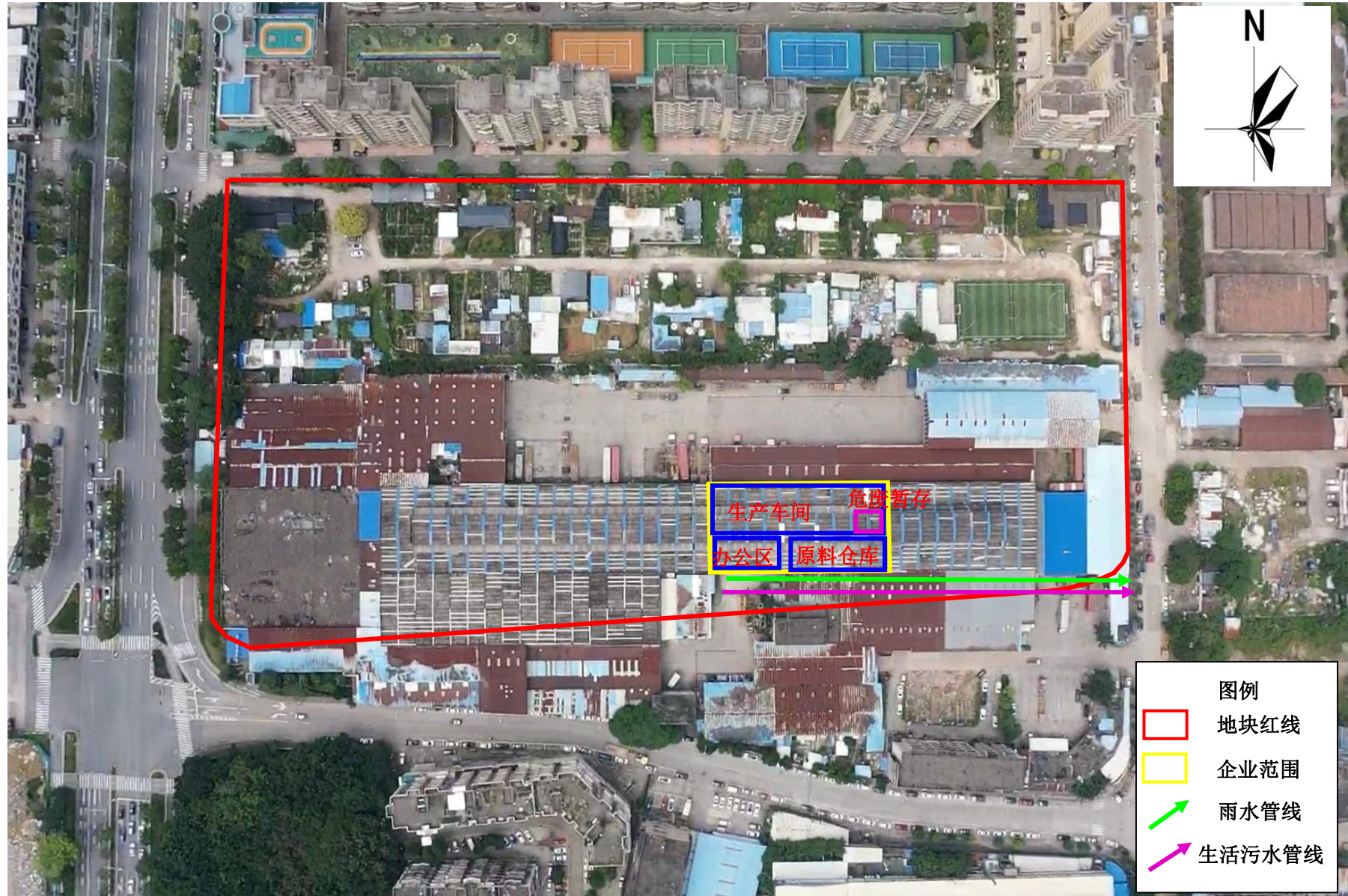
图 3.3-19 江门市蓬江区正鸿广告制作部生产平面布置及雨水污水管网图 (2023 年 01 月-2023 年 06 月)
