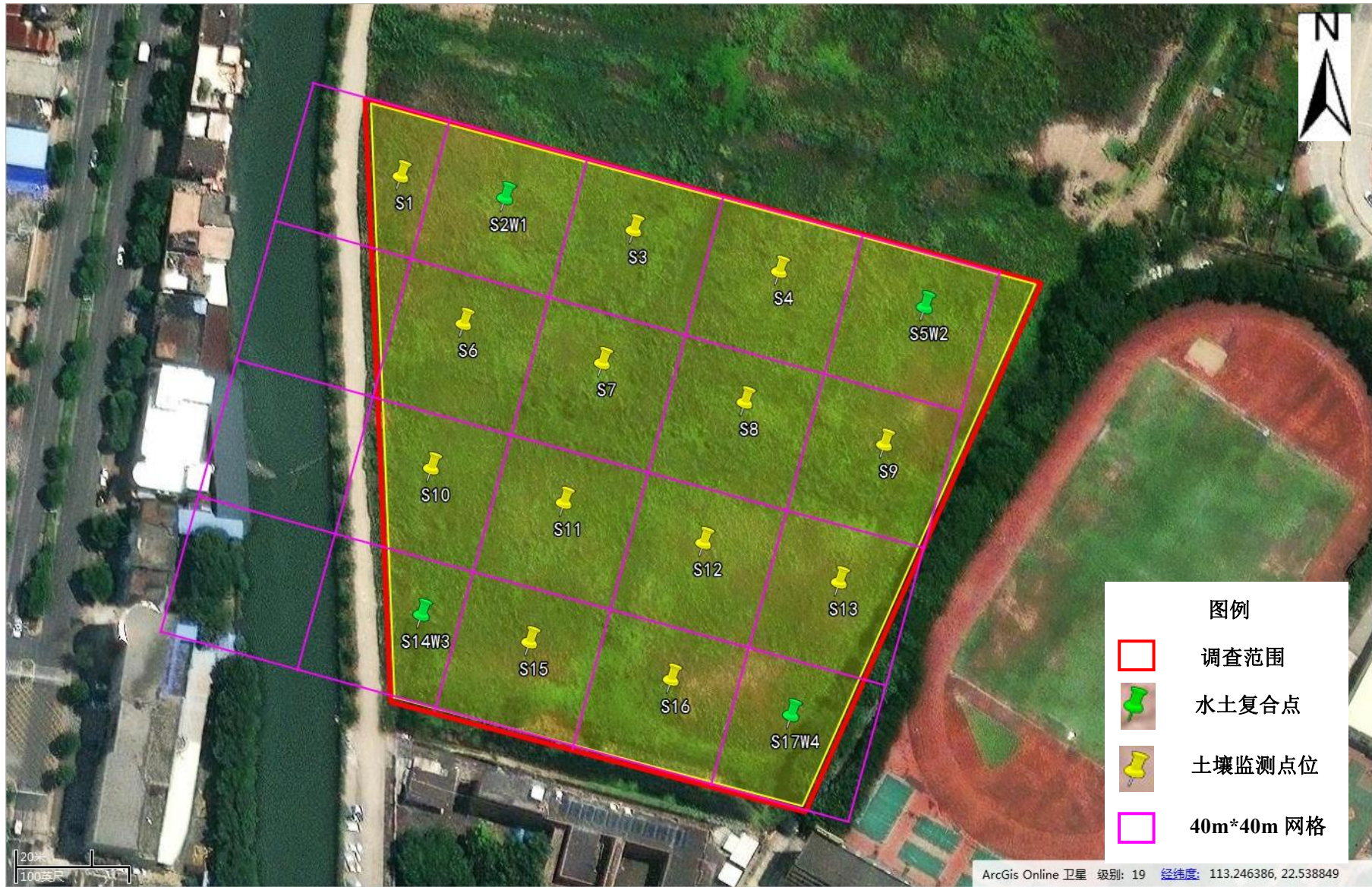
图 4.2-1 地块内土壤和地下水监测点位布设示意图
