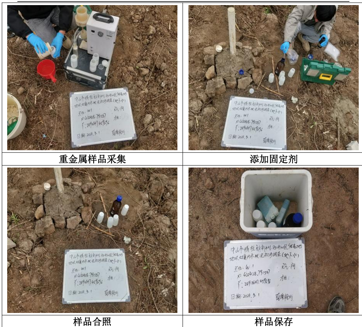
图4.5-2初步调查地下水现场采样照片
