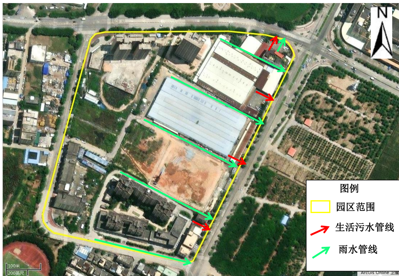
图 3.5-3 恒涛工业区雨污水管网分布图
