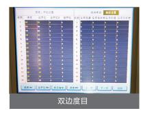
织片两边的度目松紧可控制,只需几个数值 简单操作,无需人工调节,就可调整衣片两 边长短,提升生产的稳定性和连贯性。
