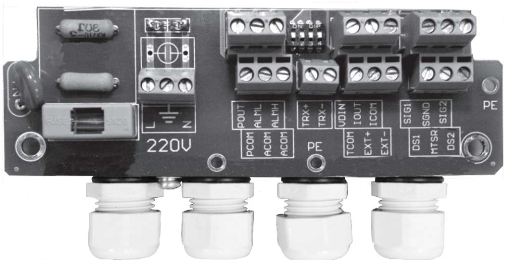
图6.3(a) 方表接线端子图
