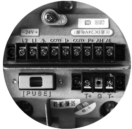
图6.3.4 圆表接线端子图
