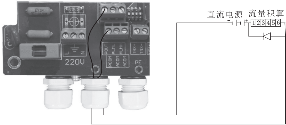
图6.4 (b) 方表电磁计数器接线
