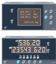
外形尺寸: 160 × 80 × 115mm 开孔尺寸: 152_{-0}^{+0.7} \times 76_{-0}^{+0.7} mm
