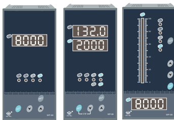
外形尺寸: 80×160×115mm 开孔尺寸: 76_{-0}^{+0.7} \times 152_{-0}^{+0.7} mm
