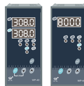
外形尺寸: 48×96×115mm 开孔尺寸: 45_{-0}^{+0.7} \times 92_{-0}^{+0.7} mm
