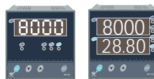
外形尺寸: 96×96×115mm 开孔尺寸: 92_{-0}^{+0.7} \times 92_{-0}^{+0.7} mm
