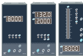
外形尺寸: 80×160×115mm 开孔尺寸: 76_{-0}^{+0.7} \times 152_{-0}^{+0.7} mm
