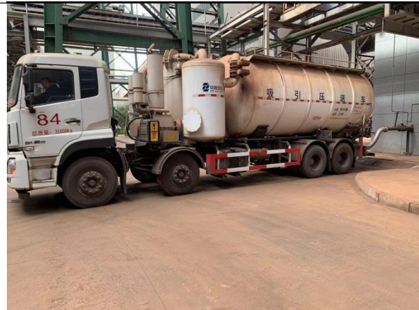
脱硫灰罐车运输
