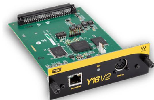
WSG-Y16 V2 mini-YGDAI I/ O Card,适用于YAMAHA调音台，16个I/O通道
