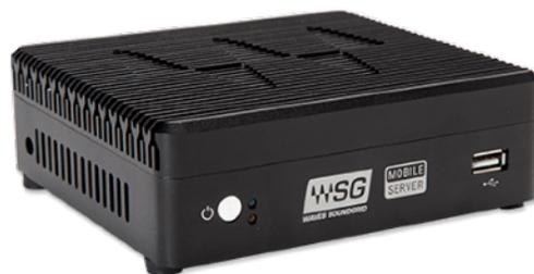
SoundGrid Mobile Server服务器（使用Intel Skylake Core i5-6200u CPU，4G内存）
