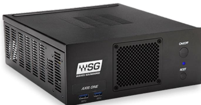
Axis One电脑主机（定制设计和优化的标准化计算机，用于运行Waves音频应用程序。Axis One采用耐用的半机架式2U机箱，是现场音响，广播和工作室的值得信赖的解决方案。）
