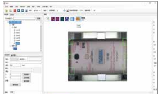
手机装饰件、槽尺寸测量
