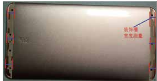
手机装饰件、槽尺寸测量
