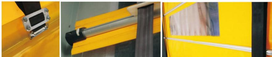
许多铝合金抗风杆均匀分布在门体上，将PVC布连接为一体。这些抗风杆提供了极好的抗风性能。特殊设计的背带结构，让动力通过轴传送给多条背带带动大门运行。
