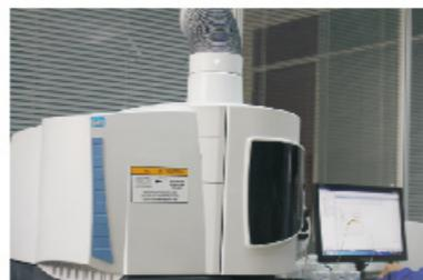
电感耦合等离子发射光谱仪
