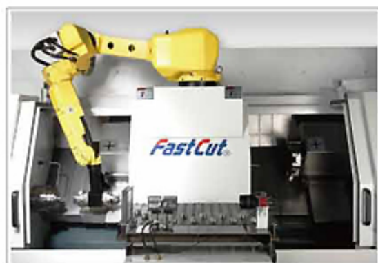
▲ 機械手機台A送收料 Robot arm for machine A.
