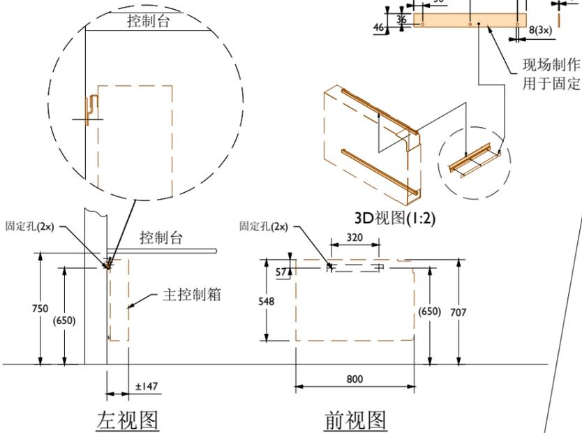
主控制箱的支架支撑 (无比例)
