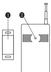
① 磁铁块：与门磁开关配合实现报警功能。安装时两者位置如左图示，在磁铁块离开门磁时，门磁开关报警指示灯亮。
