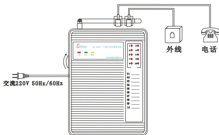
2> 系统外线输入接电信市话线输入，外接电话机平时可作为普通电话机使用；进入编程状态后，外接电话机将作为编程键盘使用。
