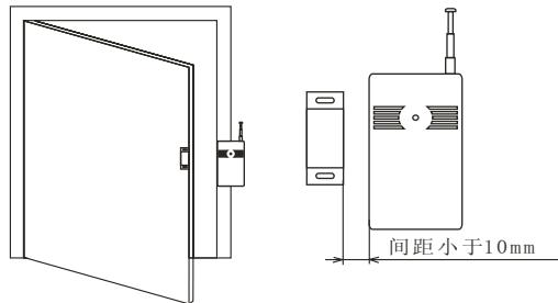
1、门磁开关应根据进入开门的最小角度确定安装位置。
