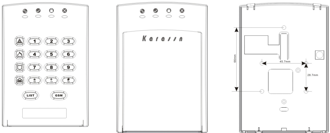
图四 键盘底盖面板图和安装图
