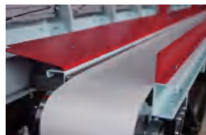
落纱自动输送系统 Auto-doffing conveyor system
