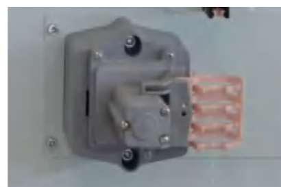
门栅式张力器 Comb tensioner
