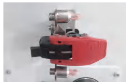
空气网络喷嘴 Air intermingler
