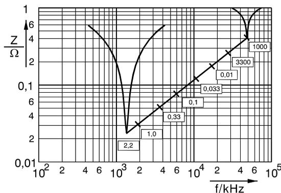
Wechselspannungsbelastbarkeit in Abhängigkeit von der Frequenz bei sinusförmiger Belastung, Richtwerte bis 40°C:
