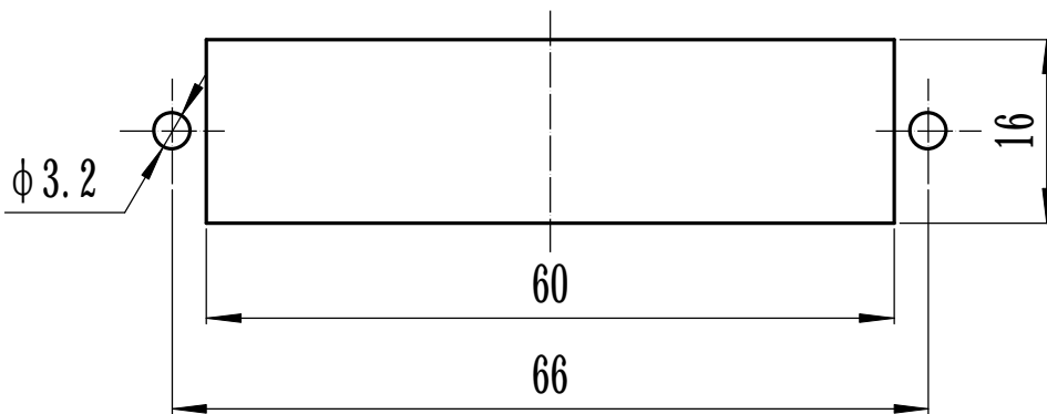
插座安装开孔尺寸
