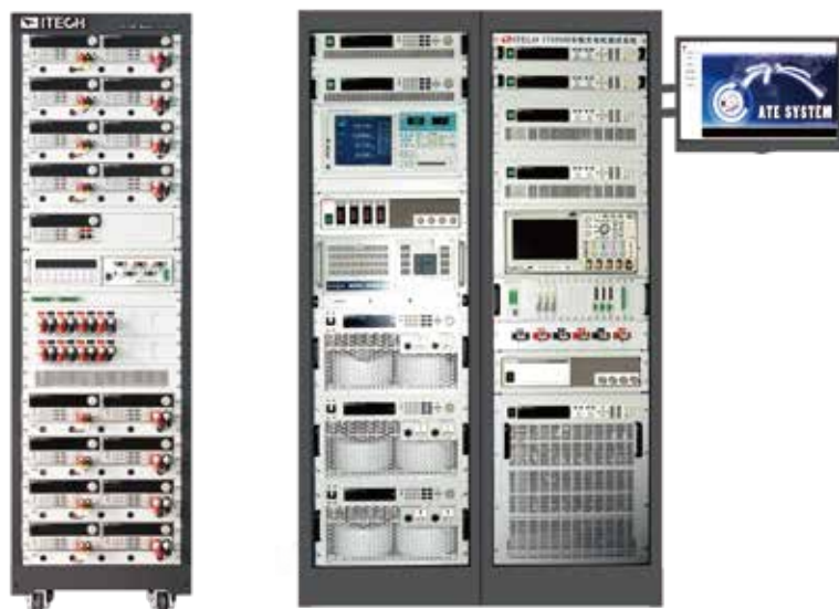
电池包可靠性及 充放电性能测试系统
