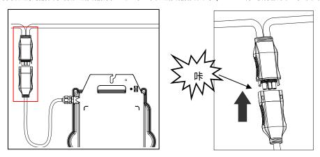
使用总线拆卸治具拆分连接器。
