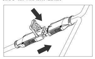
保护未使用的连接器,盖上总线Y头保护盖。
