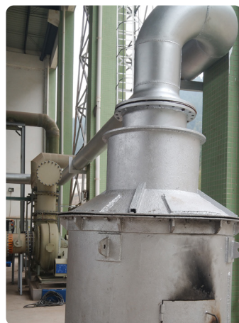
废渣处理：电解炉产生的锂渣，通过焚烧炉点火焚烧，焚烧后的锂渣数量降低，且更易保存，不仅减少了包装材料的使用，且可回收利用
