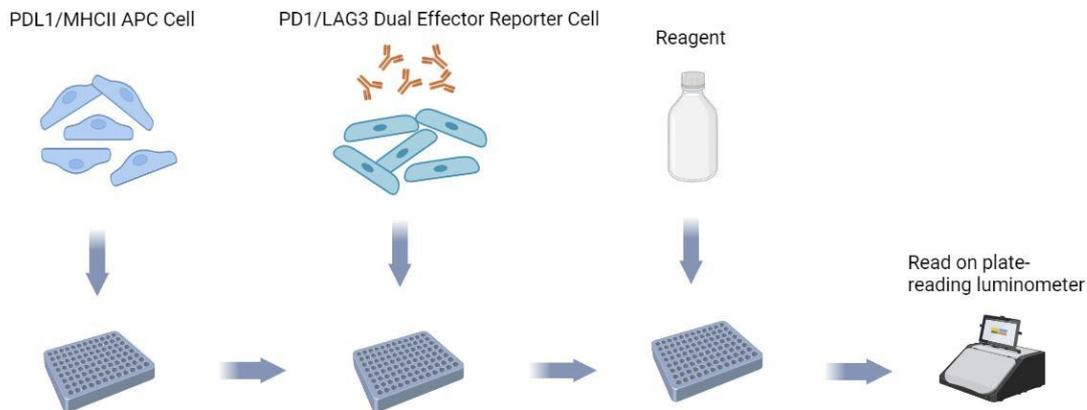
图 3: PD1&LAG3 Blockade Assay 流程示意图
