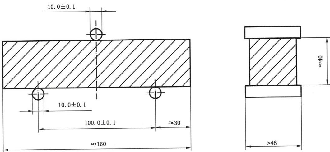
图 7 抗折强度测定加载示意图
