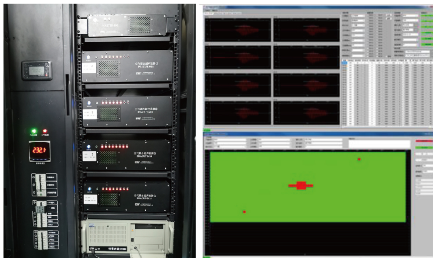
组网 64 通道空气耦合超声检测系统 ( 型号：DM16 )
