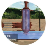
管道不停输带压开孔示意图
