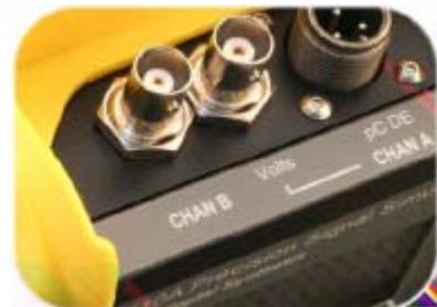
**電壓與電荷輸出：**MTI1510A 訊號產生器有電荷訊號模式,可以模擬加速規和其他壓電式的感測器,而電壓輸出模式可以模擬多種電壓輸出的感測器
