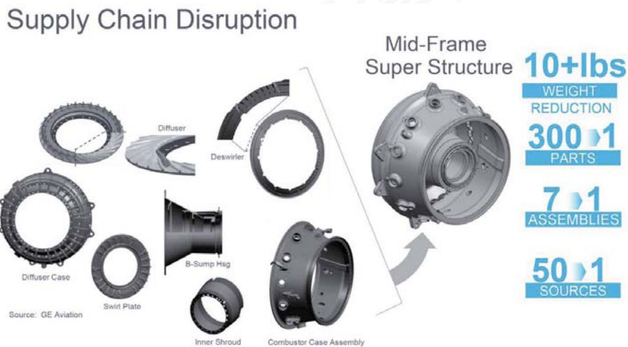
图 38 增材制造对航空发动机轻量化和减少零件数量的贡献(来源: GE Aviation)
