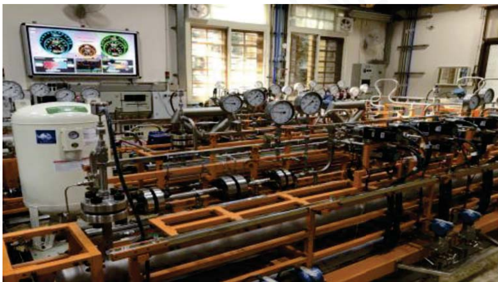
图 26 超临界二氧化碳循环实验管网系统（来源：Flownex）
