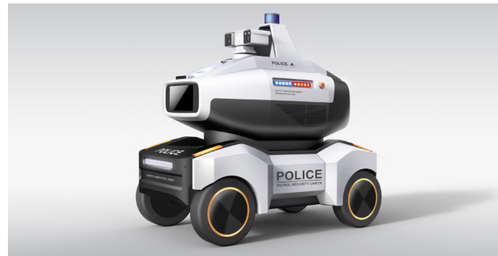
图 2.22 安防巡检机器人
