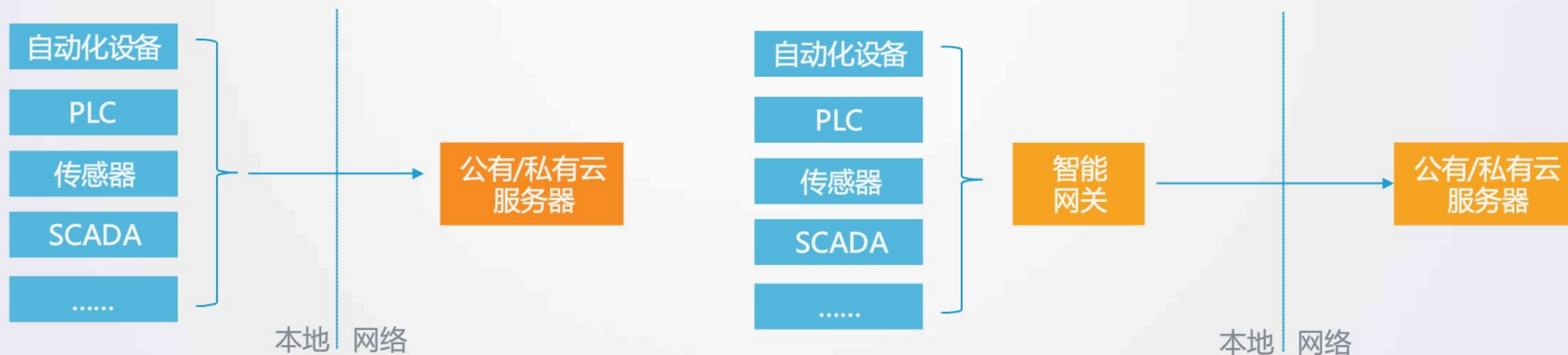
工业数据采集分析的云计算架构和边缘计算架构示意
