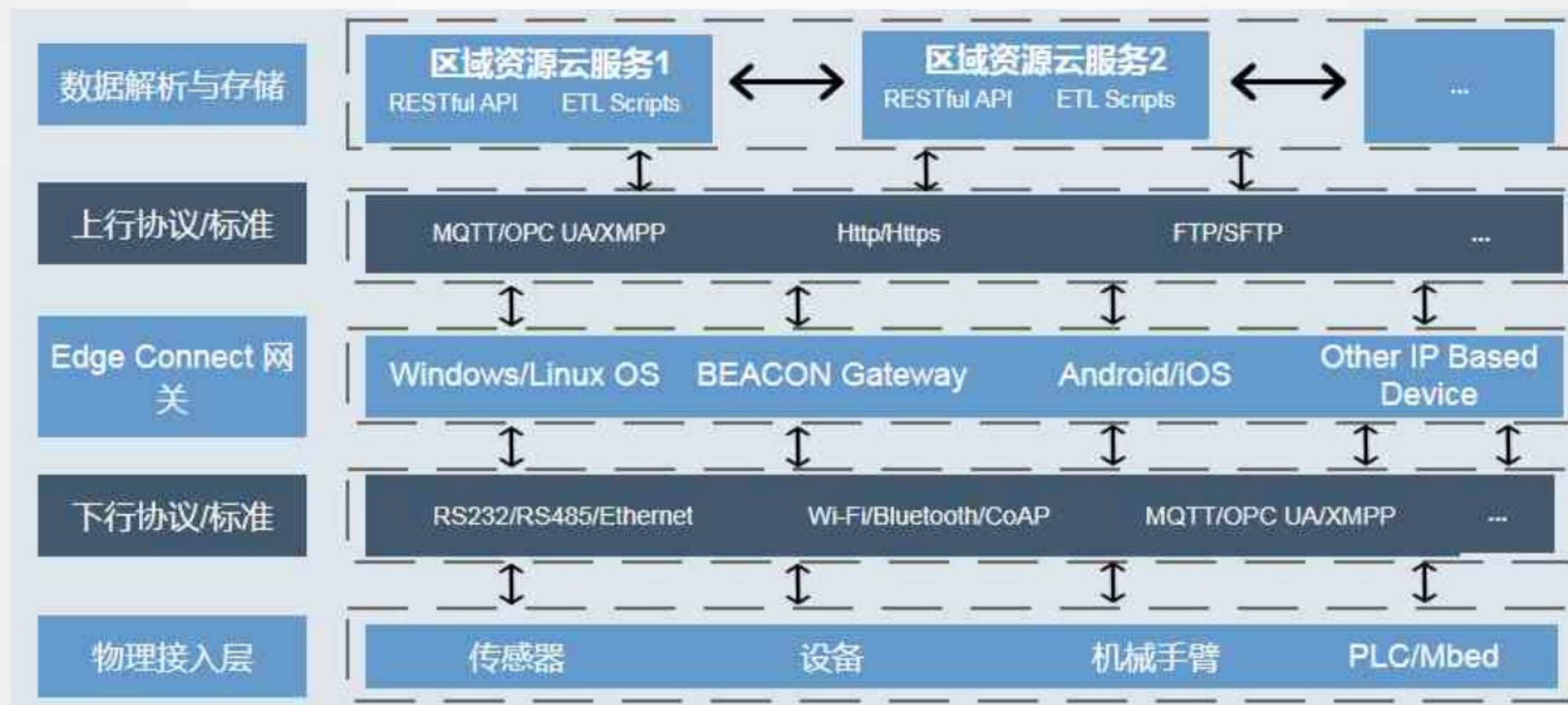
工业设备接入与数据传输各层结构
