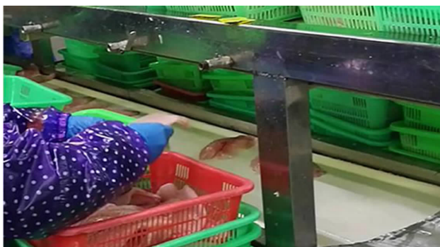
图 1b 冷冻鱼片加工过程中的小鱼刺处理步骤 (工人手指触摸和眼睛观察来去除小鱼刺)
