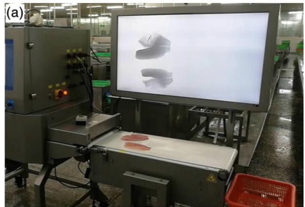
图 5 多片鱼片的检测。(a) 采用高速显示延迟线阵 X 射线检测系统对两片鱼片进行检测。(b) 三片鱼片的 X 射线照片。
