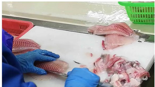
图 1a 冷冻鱼片加工过程中的鱼片切片步骤(直接用刀去除大鱼刺)
