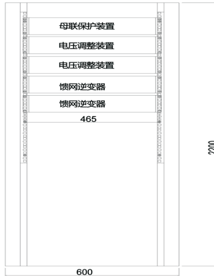
19寸标准机柜正面安装示意图， 机柜长宽深：2200*600*600 mm 其中长度尺寸可根据实际情况自定
