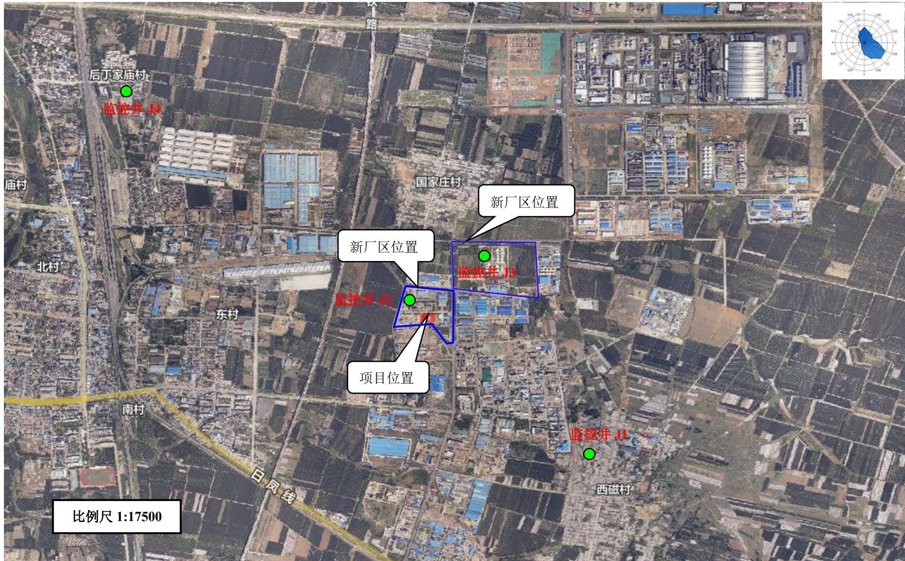
图 6.5-3 厂区地下水监控井分布图
