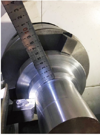
KW50机床可加工单边12mm
