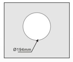
1) 在天花板上开一安装孔; Drill a hole in the ceiling;
