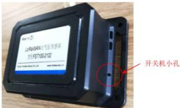
开机：需用针穿过图中小孔顶住按钮直到通过旁边的小孔看到传感器内部 LED 长亮一次；
