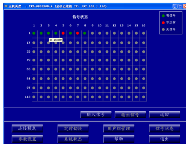
图 3.12 输入信号状态 (RGB、VGA 矩阵系列)
