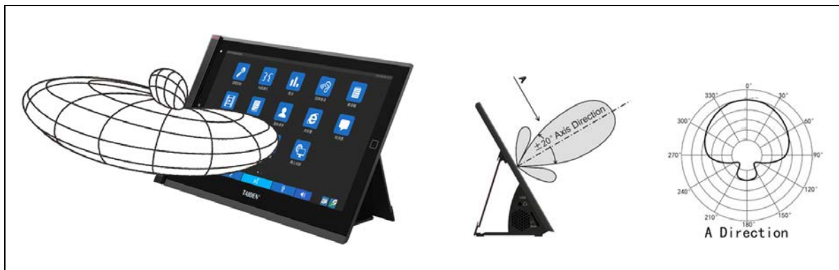
图9 HCS-8368AD/50 第三代无纸化多媒体会议终端拾音特性图
