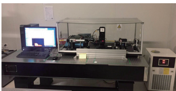
1064 nm激光损伤阈值测量系统 (CW, 100 W)
