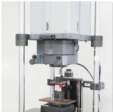
面形和不规则度（P-V）：ZYGO GPI-XP干涉仪 面形和不规则度测量精确： \lambda/50
