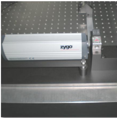
曲率半径：ZYGO双频激光干涉系统 分辨率：10nm 测量精度：3 \mu\text{m} 或0.001%
