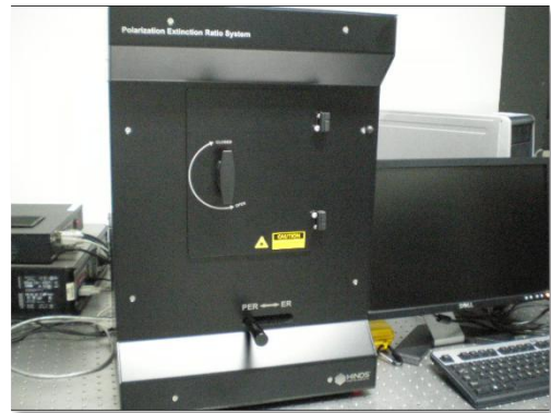
消光比测量系统 PER 测量精度： >50\text{dB} ER 测量精度： >250000:1
