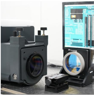
平行度、波前和平面度测量：ZYGO干涉仪 平行度测量精度：0.5" 波前和平面度测量精度： \lambda/50
