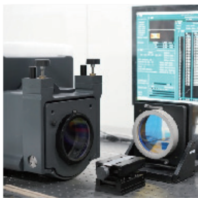
用于测量平面度、平行度的Zygo干涉仪 平面度和波前测量精度: \lambda/50 平行度测量精度:0.5''
