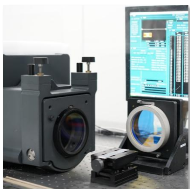
用于测量高精度波前、平面度、平行度的ZYGO干涉仪 平面度和波前测量精度： \lambda/50 平行度测量精度： 0.5''
