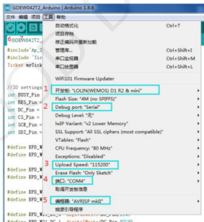
图 7 程序下载操作步骤
