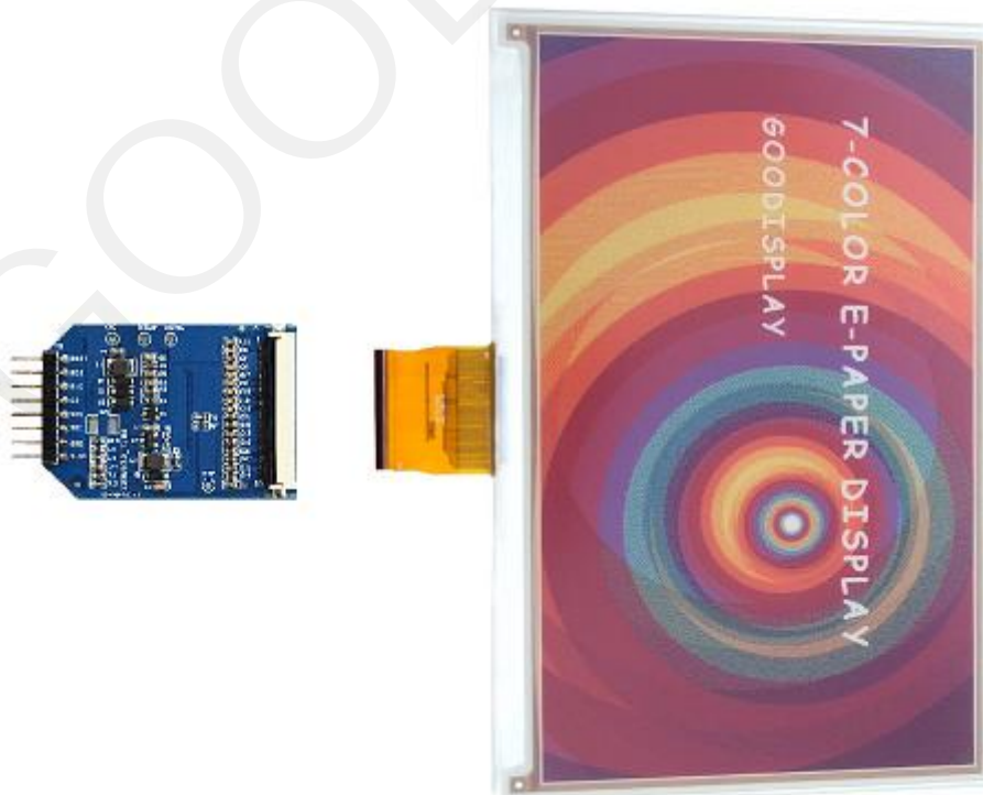
图4 电子纸显示屏与转接板插接示意图
