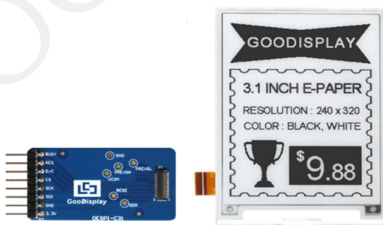
图4 电子纸显示屏与转接板插接示意图
