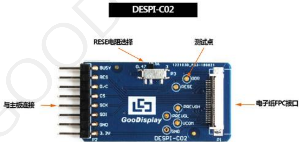
图 2 转接板 DESPI-C02 功能图
