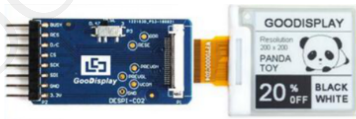
图4 电子纸与转接板插接示意图
