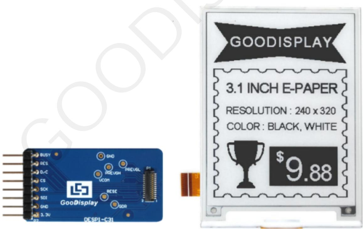
图 2 电子纸显示屏与转接板连接方式
