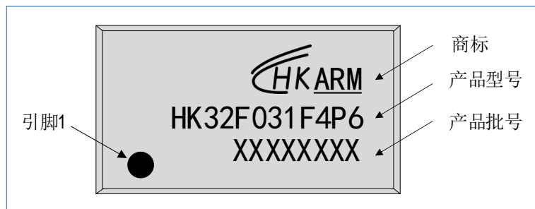
图 6-14 TSSOP20 HK32F031F4P6 丝印示例
