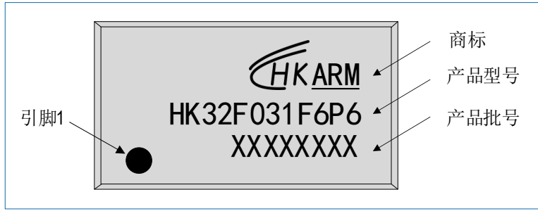
图 6-15 TSSOP20 HK32F031F6P6 丝印示例
