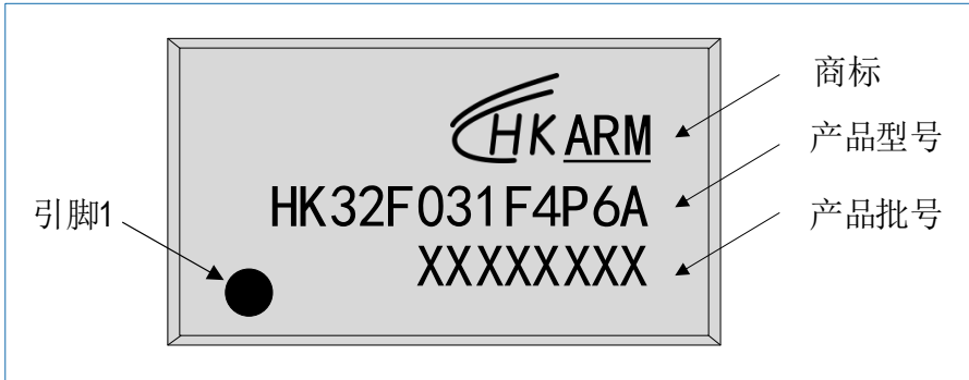
图 7-14 TSSOP20 HK32F031F4P6A 丝印示例
